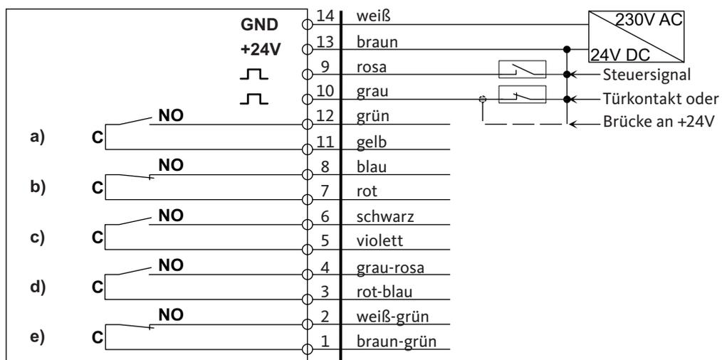
Abb.6: Kontaktzustände in Grundstellung
