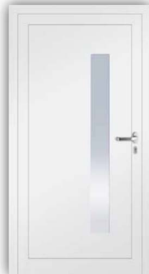
Nebeneingangstüre 4 U_D – Wert ab 1,2 w/m^2k Glaslichte = 150x1530mm
