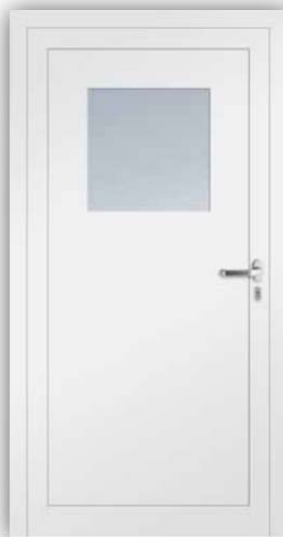
Nebeneingangstüre 3 U_D – Wert ab 1,2 w/m^2k Mindestbreite 940mm Glaslichte = 550x550mm
