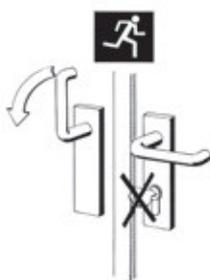
11. Bei Fluchttürverschlüssen dürfen keine Schließzylinder mit Knauf oder Drehknopf eingebaut werden.
