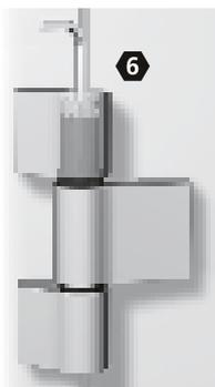
4. Lagerbuchse um  $\pm 90^\circ$  drehen bis sie spürbar einrastet (Dichtungsdruck  $\pm 0,5$  mm)
