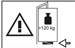
Flügel leicht anheben und Türbänder entlasten
