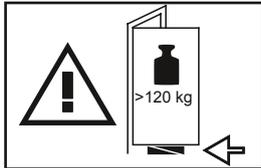
Flügel leicht anheben und Türbänder entlasten
