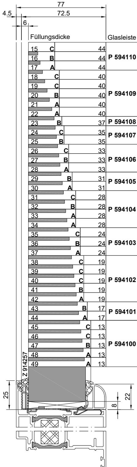
Runde Glasleisten sind in Verbindung mit Glashalter Z 917276 und Glasleistenhalter Z 912337 verwendbar
