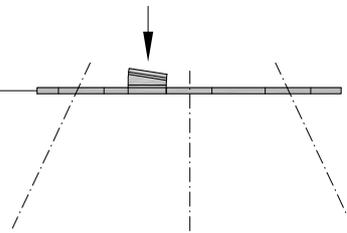
Wird der Glasträger **Z 917539** verwendet, muss in Bereich des Glasträgers die äussere Glasleiste **P 803711** ausgeklinkt werden.
