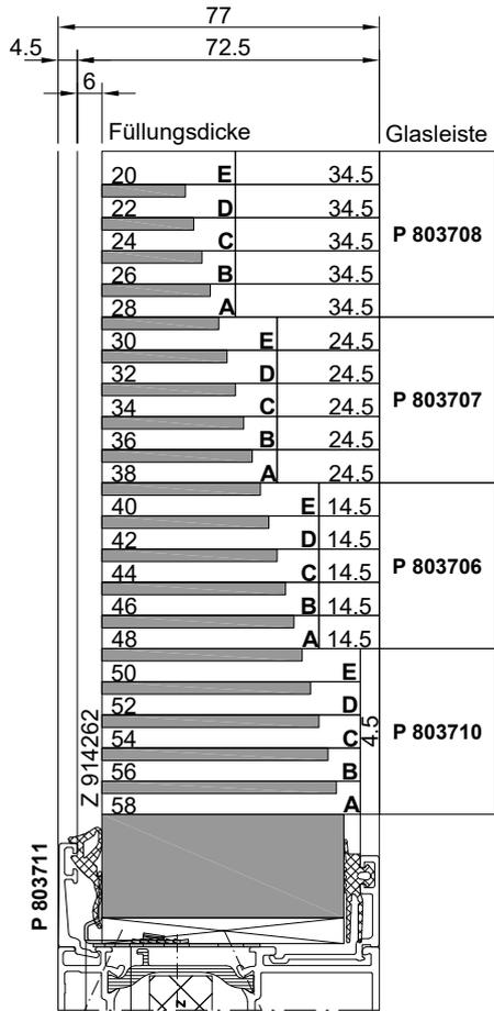
Glasleisten müssen im Bereich der Glashalter **Z 917276** ausgeklinkt werden
