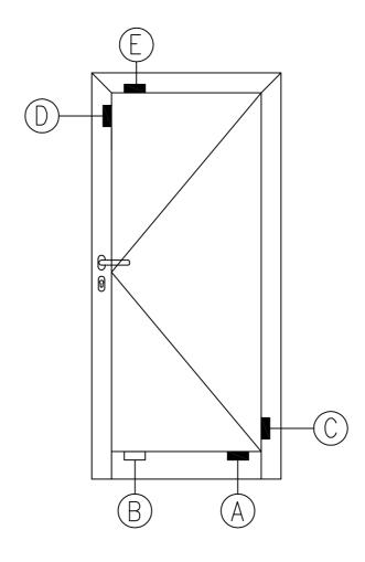
Um die einwandfreie Funktin der alu—one Elemente zu gewährleisten, muss auf sorgfältiges Verklotzen der Glas— bzw. Füllungsscheibe höchsten Wert gelegt werden.
