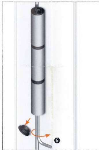
Abdeckkappe abnehmen. Höhenverstellung + 5 mm. Abdeckkappe aufstecken.
