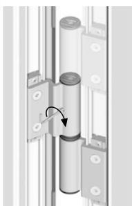
» Verstellereinheit (Pos. 2) über Madenschraube (Pos. 3) festsetzen.
