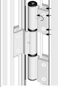
» Alle Befestigungsschrauben der oberen Rahmenbandteile lockern.
