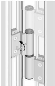
» Verstellereinheit (Pos. 2) über Madenschraube (Pos. 3) lockern.
