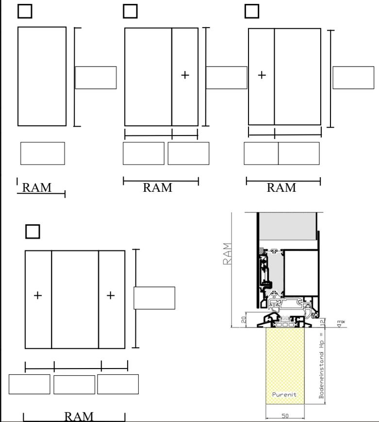
Bodeneinstand (Purenit) H<sub>p</sub>(mm)=
