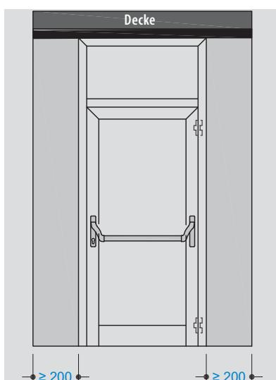
Das Element darf oberhalb an einen (bekleideten) Stahl- bzw. Holzträger, gemäß Zulassung, anschließen.
