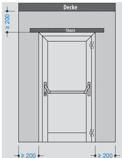
Der Sturz darf aus anderen Materialien wie z.B. Beton, Stahl oder Holz beplankt bestehen.
